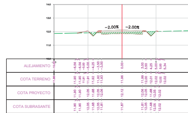
SECCION TRANSVERSAL PROG.: 0+285.16
